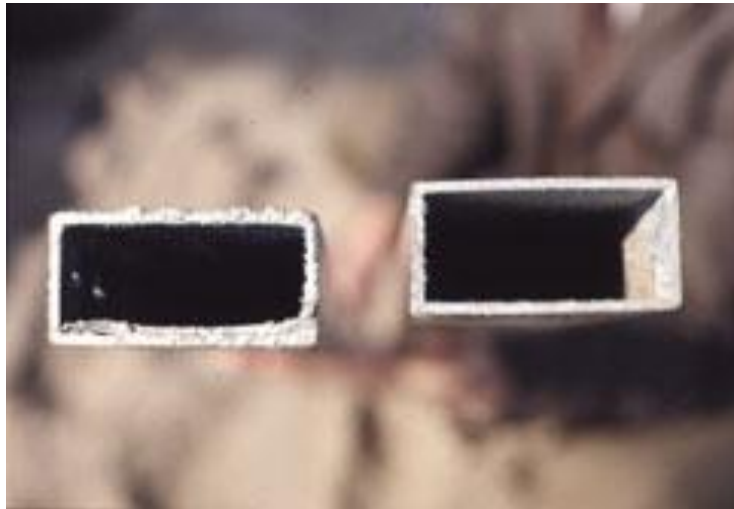
Links een braam, rechts afgebraamd
